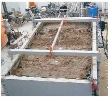
图 1 装箱完成后的模型地基土 Fig. 1 Model soil after packing
