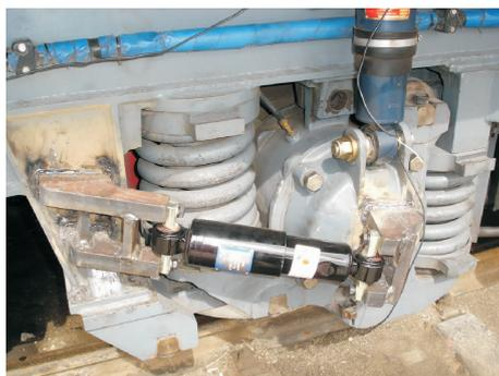
图6 一系悬挂纵向减振器布置方式
