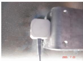
图4 轴箱传感器布置方式 图5 车体传感器布置方式
