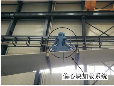
图 6 疲劳加载试验现场
