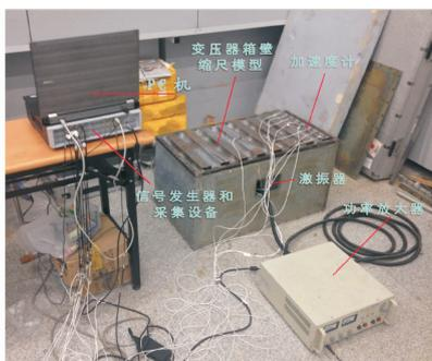
图4 电力变压器缩尺模型测试系统示意图
