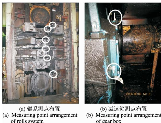
图 1 相关设备的振动测试
