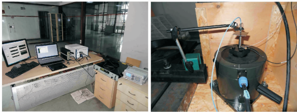
图 9 微位移主动隔振控制系统实验平台
