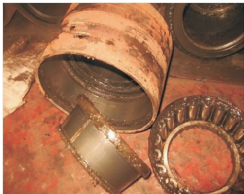
图 5 铁路货车内圈故障轴承
