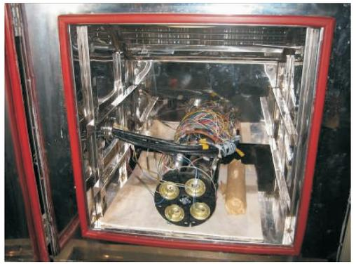
图 16 发动机推进剂高温膨胀应力增加试验
