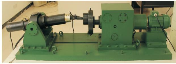
图 14 我国首台高速旋转弹丸三自由度角运动模拟装置
