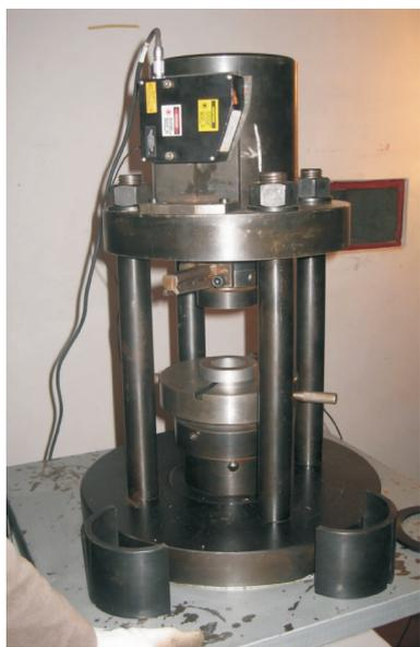
图 11 我国首台发射装药动态挤压破碎试验装置
