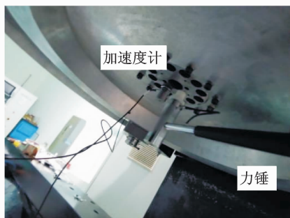
图 9 机床气浮主轴锤击模态实验
