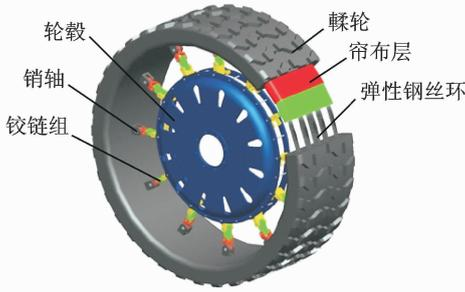
图 1 机械弹性车轮结构
