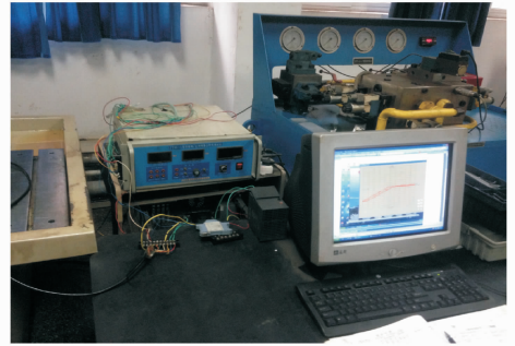
图 1 液压泵振动测试实验系统
