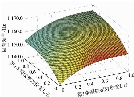
图 2 裂纹深度一定时,裂纹梁第 1 阶固有频率随着裂纹相对位置的变化规律
