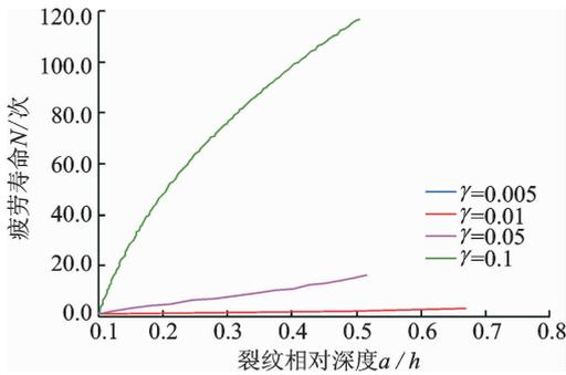
图 4 共振状态下,不同阻尼时该裂纹梁的疲劳寿命
