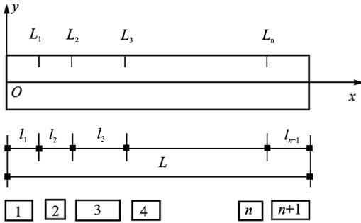
图 1 多条裂纹梁模型
