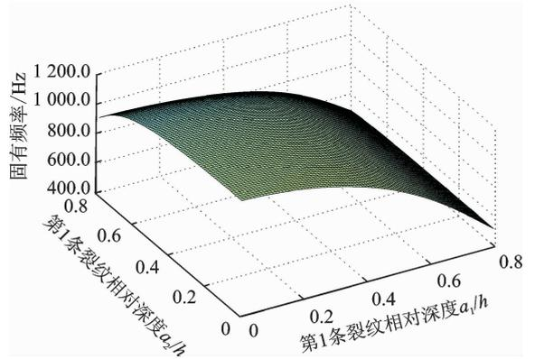
图 3 裂纹相对位置固定时,裂纹梁第一阶固有频率随着裂纹深度的变化规律
