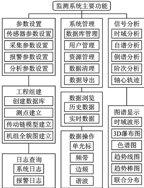
图 11 振动监测系统主要功能和分析方法
