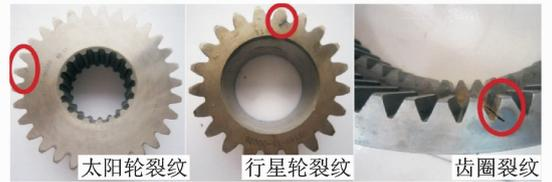
(b) 3种齿轮裂纹损伤形式
