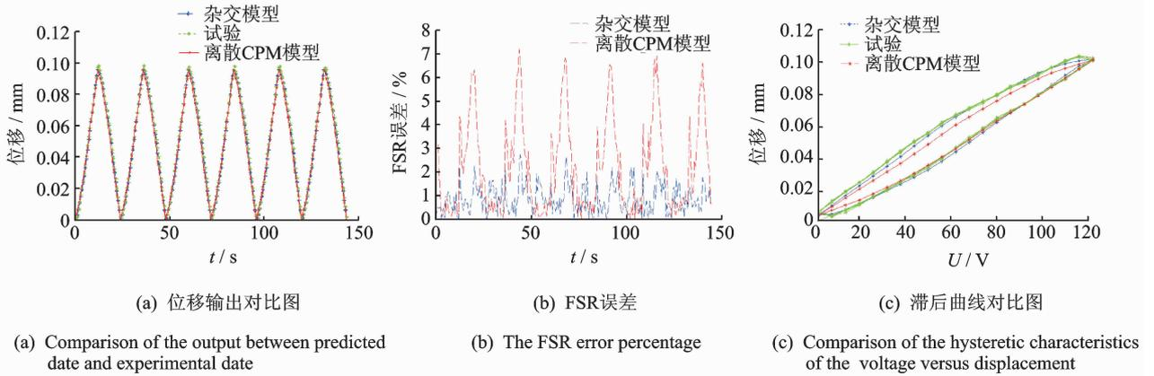
图 12 三角波激励下经典离散模型、杂交模型和实测输出对比图
