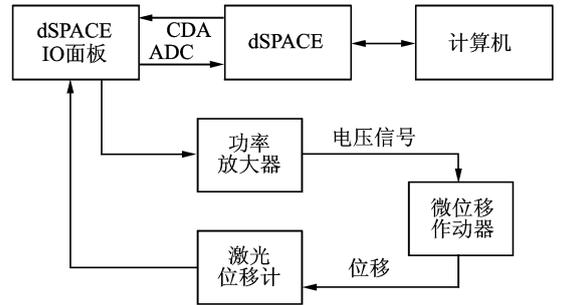
图 4 测试试验原理结构框图
