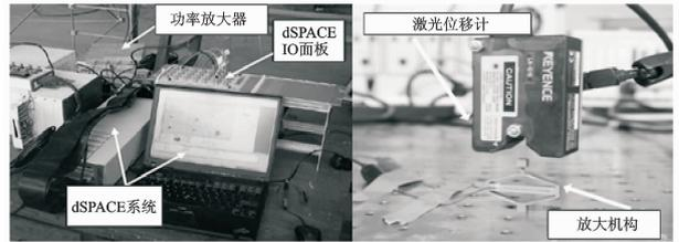
图 3 1 阶滞回曲线试验系统
