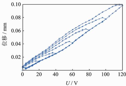
图 7 菱形压电作动器 1 阶滞回曲线
