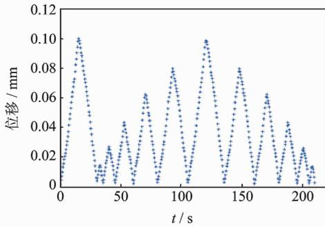
图 6 菱形压电作动器输出位移
