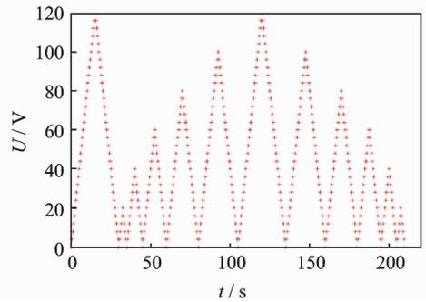
图 5 压电作动器的输入电压
