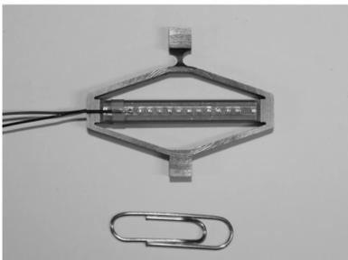
图 2 菱形微位移压电作动器实物图
