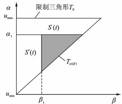
图 8 Preisach  $\alpha$ - $\beta$  平面Fig. 8 The Preisach  $\alpha$ - $\beta$  plane
