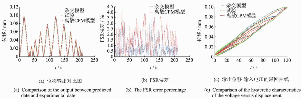
图 13 线性分段折返激励下经典离散模型、杂交模型和实测输出对比图
