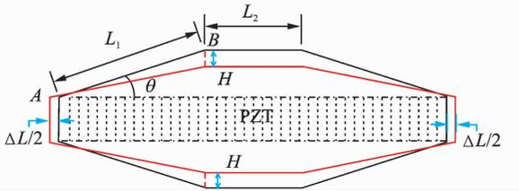
图 1 菱形微位移压电作动器结构示意图
