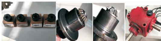
图 5 故障轴承及故障齿轮
