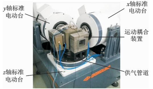
图 10 三轴向振动台实验样机
