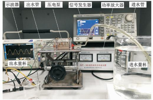
图 3 泵流量试验照片
