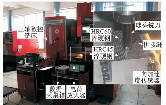
图 3 淬硬钢拼接件加工现场
