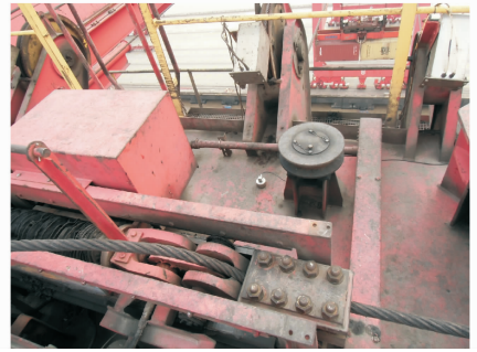
图 10 大梁最前端振动加速度测点 Fig. 10 The acceleration test point on the boom tip
