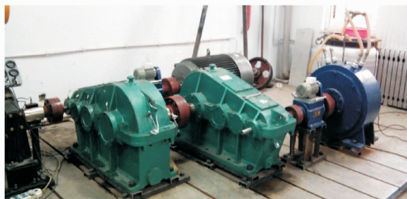
图 3 齿轮箱传动系统总体结构
