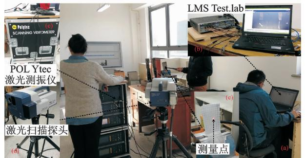
图 4 叶片振动特性试验
