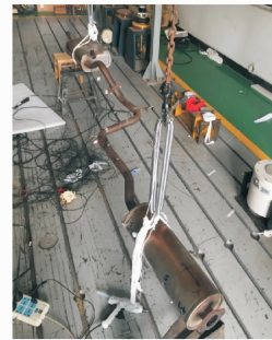
图 12 某三厢车排气系统物理模型
