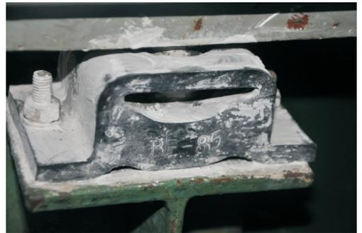
图 3 橡胶减振器失效形式
