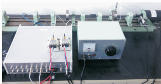
图 3 转子故障模拟实验台
