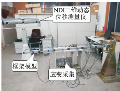
图 3 实验框架模型及测量系统结构
