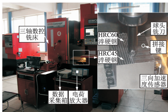
图4 淬硬钢拼接件加工现场
