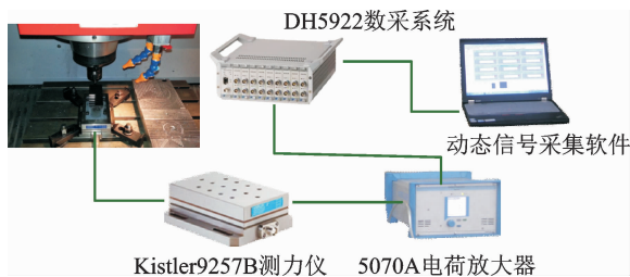
图 3 试验加工测量现场原理图
