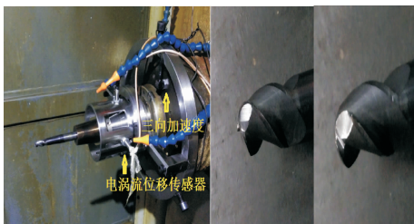
图7 实验装置与铣刀状态
