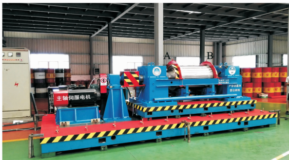
图 7 大型转子振动测试试验台 Fig. 7 Large rotor vibration test bed
