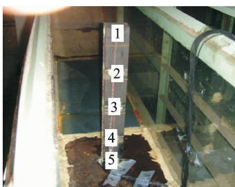
图 2 测点及温度补偿片布置图
