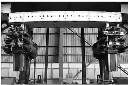
图 9 盾构管片拼装机实验图
