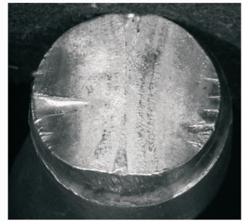
图 12 转向节臂裂纹源形貌
