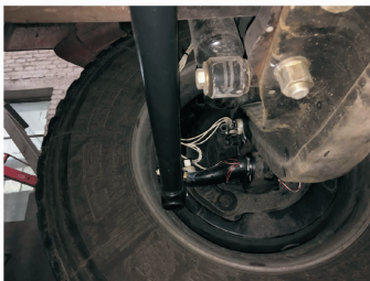
图 5 前轮轴头的加速度传感器
