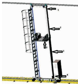
图7 加速度传感器布置位置示意图
