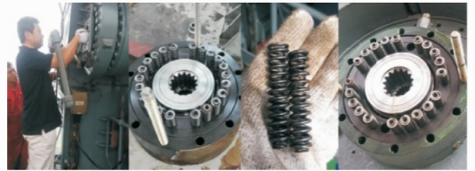
图 8 齿轮箱刹车故障验证
