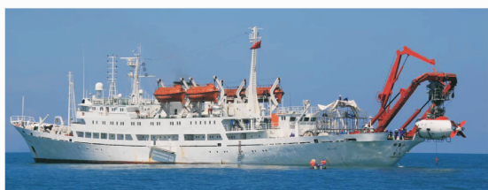
图 1 “蛟龙号”水面支持系统图
