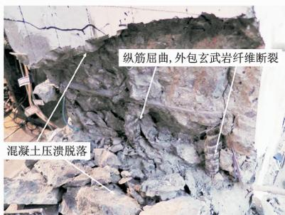
图 5  $Z_3$  柱脚局部破坏形态
