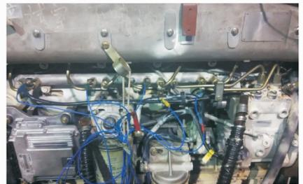
图 8 高压油管振动试验测试
