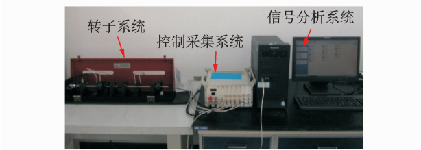
图 2 转子实验台及其测试系统 Fig. 2 Rotor test rig and the test system
