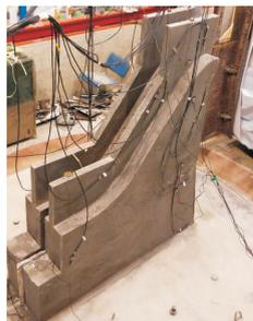
图7 溢流坝段模型浇筑成型图
