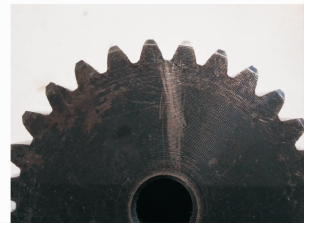
图 6 齿根裂纹太阳轮
