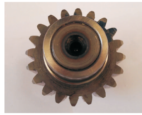
图 5 齿根裂纹行星轮
