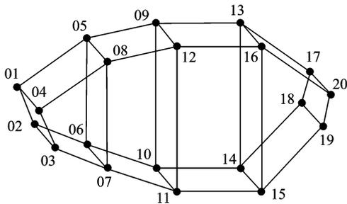
图 10 齿轮箱测点布置
