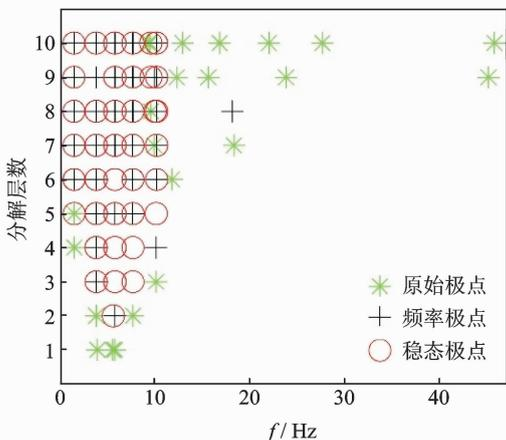
图 6  $\alpha = 64$  时 TEO 算法模态参数极点稳态图
