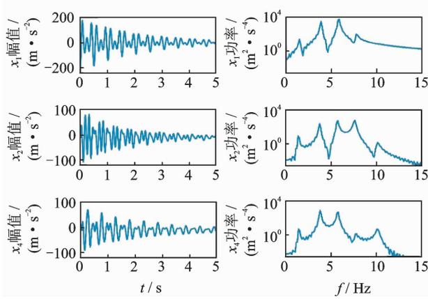
图 2 系统的时域自由振动响应和相应的功率谱密度
