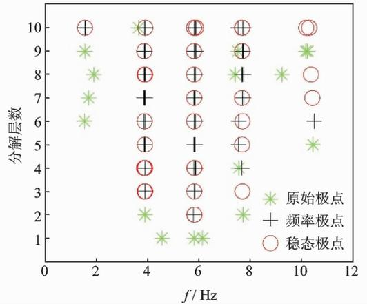
图 5 TEO 算法模态参数极点稳态图
