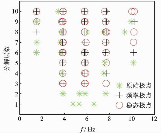
图 4 中心频率模态参数极点稳态图
