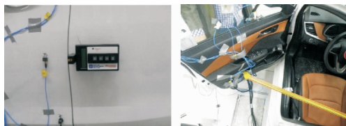
图2 关门速度计及橡皮绳关门装置
