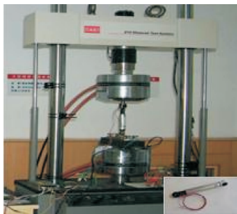
图 2 磁流变阻尼器试验装置
