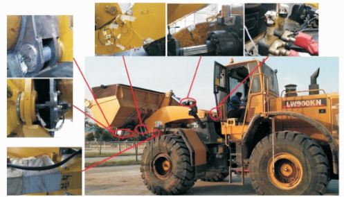
图 7 测试样机与传感器安装
