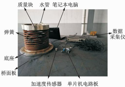
图 3 自适应 TMD 试验模型图
