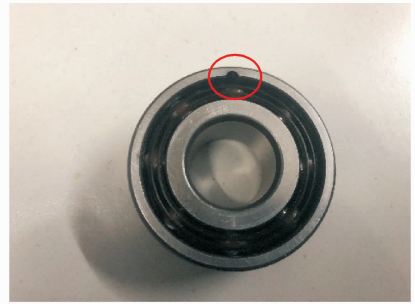
图 21 裂痕故障程度实物图
