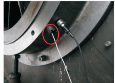
图 4 叶轮进口处传感器安装位置
