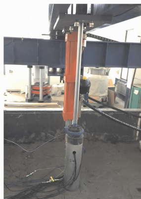
图 5 静力沉桩过程
