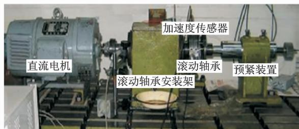
图4 轴承试验台装置
