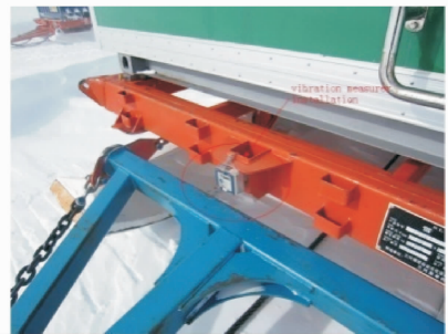
图 1 安装在雪橇上的测振仪
